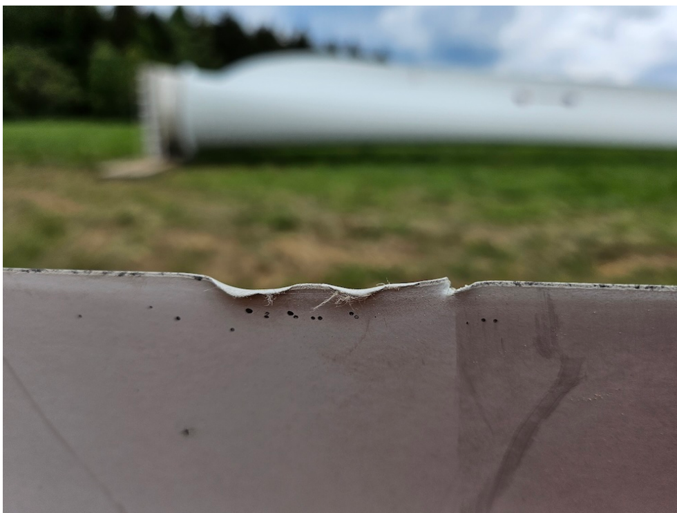
Fotografie poškození lopatek blesky FOTO: WINDENERGY
