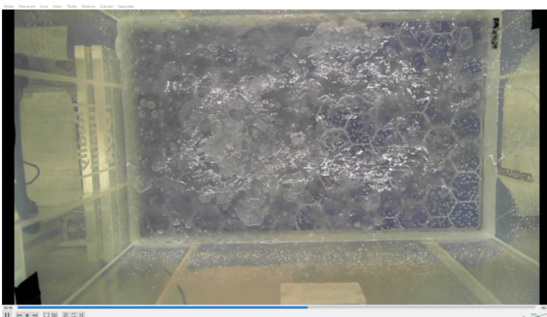
Pětkrát zrychlené video ukazuje soubor fází, během nichž se kapalná voda mění v led, ale zároveň v důsledku nízkého tlaku vře. Vzniká tak ledová krusta, která se opakovaně rozpadá, a tím se prodlužuje doba, po kterou voda vře.
