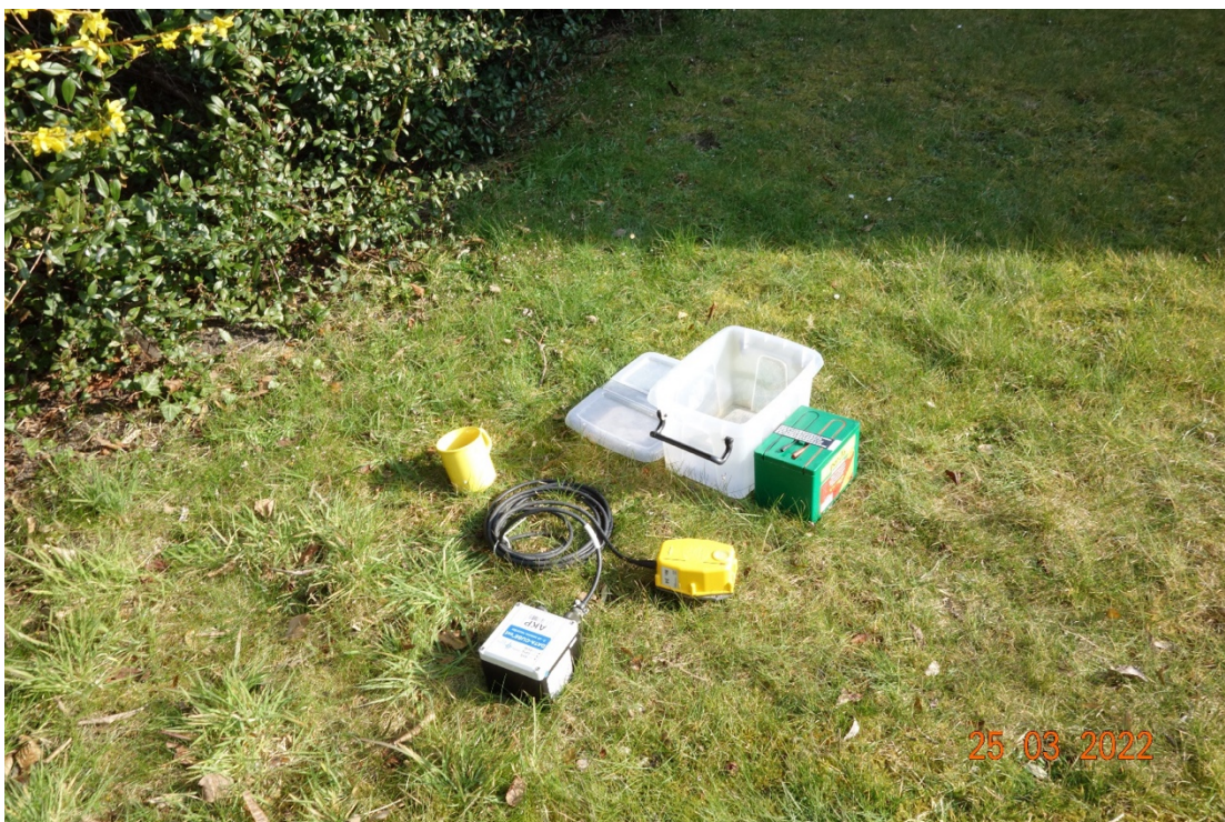
Ukázka vybavení seismické stanice s geofonem (žlutá krabička), digitizérem (šedo-černé zařízení) a suchou alkalickou baterií, která se používá pro elektrické ohradníky a neobsahuje olovo, rtuť ani kadmium (zelený kvádr). Geofon je celý zakopaný pod zemí, baterie a digitizér jsou umístěny v boxu částečně skrytém pod zemí. Ochranný box vyčnívá asi 5 cm nad povrch.
