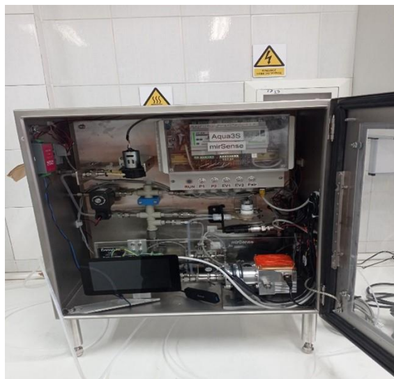
Finální verze spektroskopického senzoru, která byla předvedena v pilotní fázi projektu aqua3S FOTO: FZÚ AV ČR
