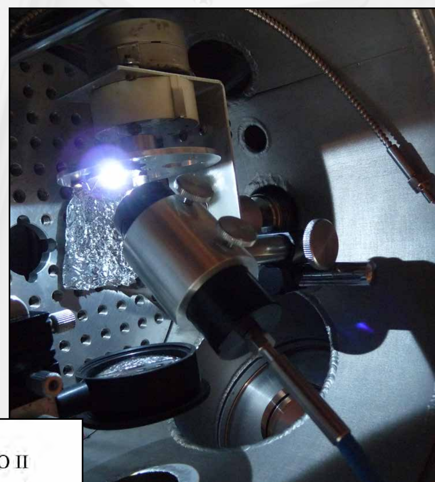
Ablací plazma meteoritu snímána objektivem kolimátoru, který je připojen k vysoce rozlišujícímu spektrografu echelle
