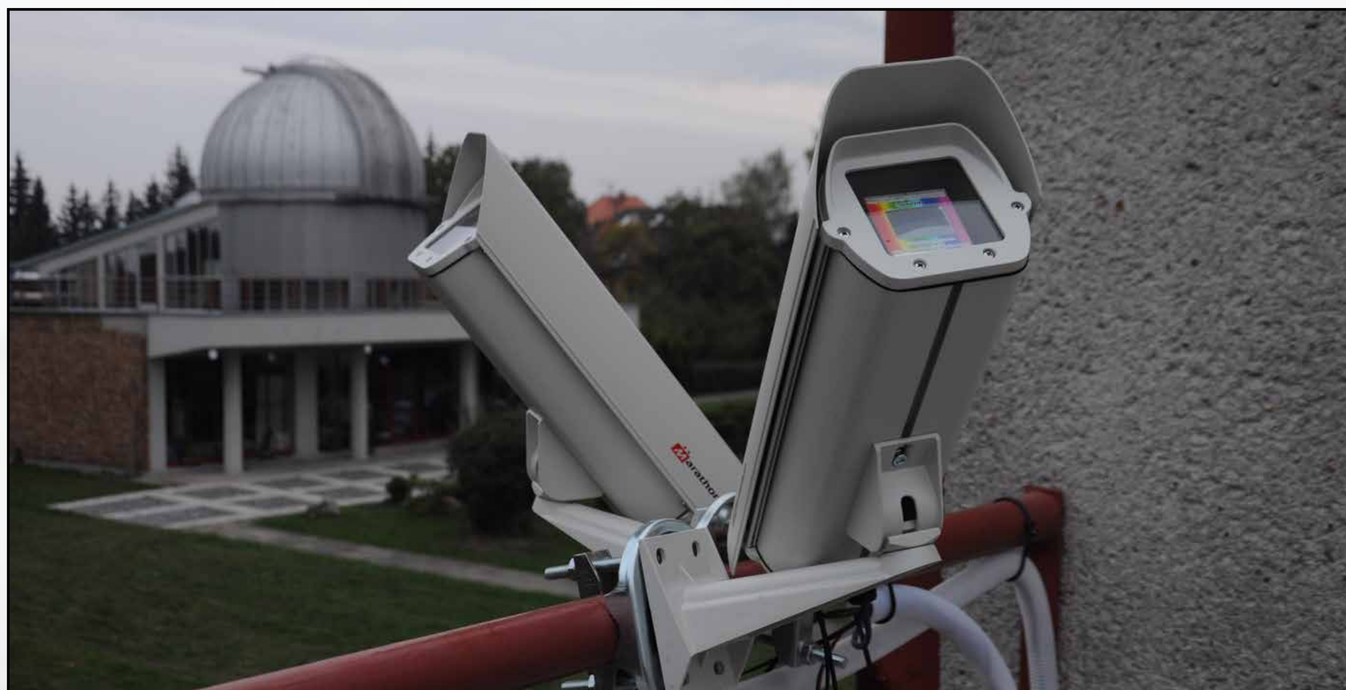
Kamera QHY5LII-M, zakoupená v roce 2015 v projektu Regionální spolupráce AV ČR reg. č. R200401521, dovozuje pořizovat spektra s rozlišením 0,97 nm/px
