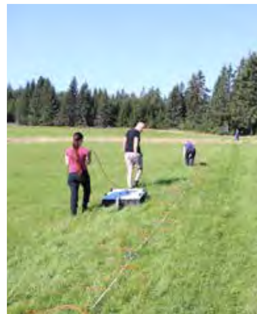
Geofyzikální měření na Rolavě s využitím zemního radaru. Foto P. Hasil
