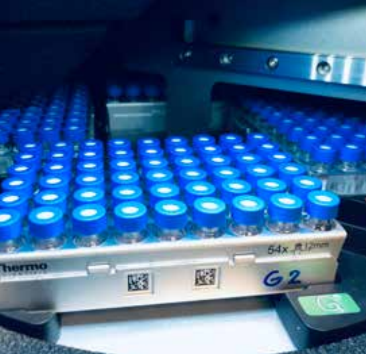
Automatický dávkovač (autosampler) vzorků, který je součástí sestavy kapalinového chromatografu a hmotnostního spektrometru (LC-MS) pro analýzu organických sloučenin
