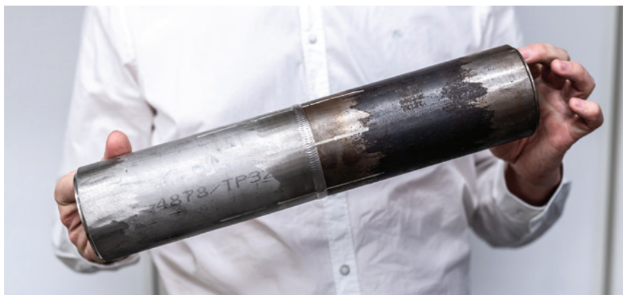
Nedávno výzkumníci zvládli ošetřit laserem zevnitř svar trubky o průměru pouhých sedm centimetrů, kterou v jaderné elektrárně teče chladivo odvádějící teplo z reaktoru.
