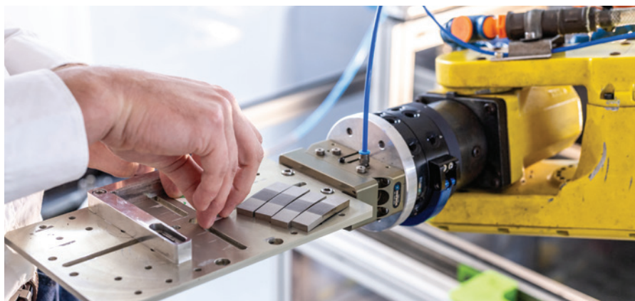
Menší vzorky pro laserové vyklepávání badatelé umísťují na univerzální držák připevněný k robotickému rameni. Robot pak opracovává kus pohybuje.
