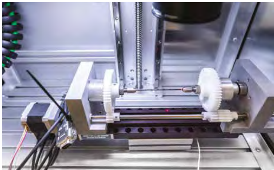
Teplná úprava superelastického drátu z nitinolu pomocí laseru. Drát napnutý na požadovanou délku rotuje kolem své osy a posouvá se k laserovému svazku.
