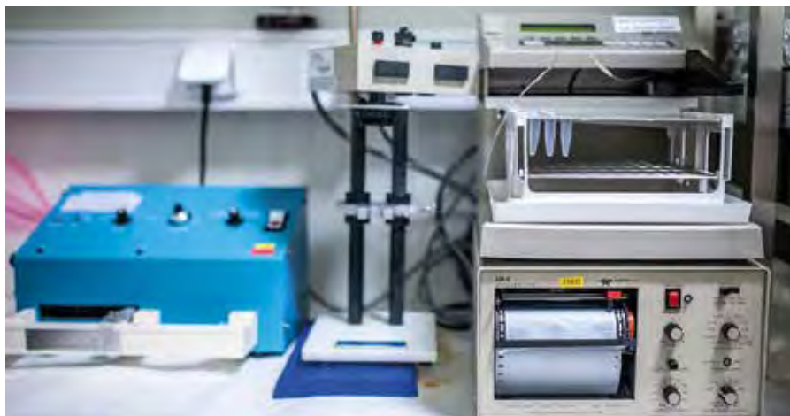
Frakcionátor umožňuje oddělit jednotlivé ribozomální podjednotky od sebe a posbírat je do separátních zkumavek. Díky tomu je lze dále studovat, což se plně využije díky grantu Akademické premie.
