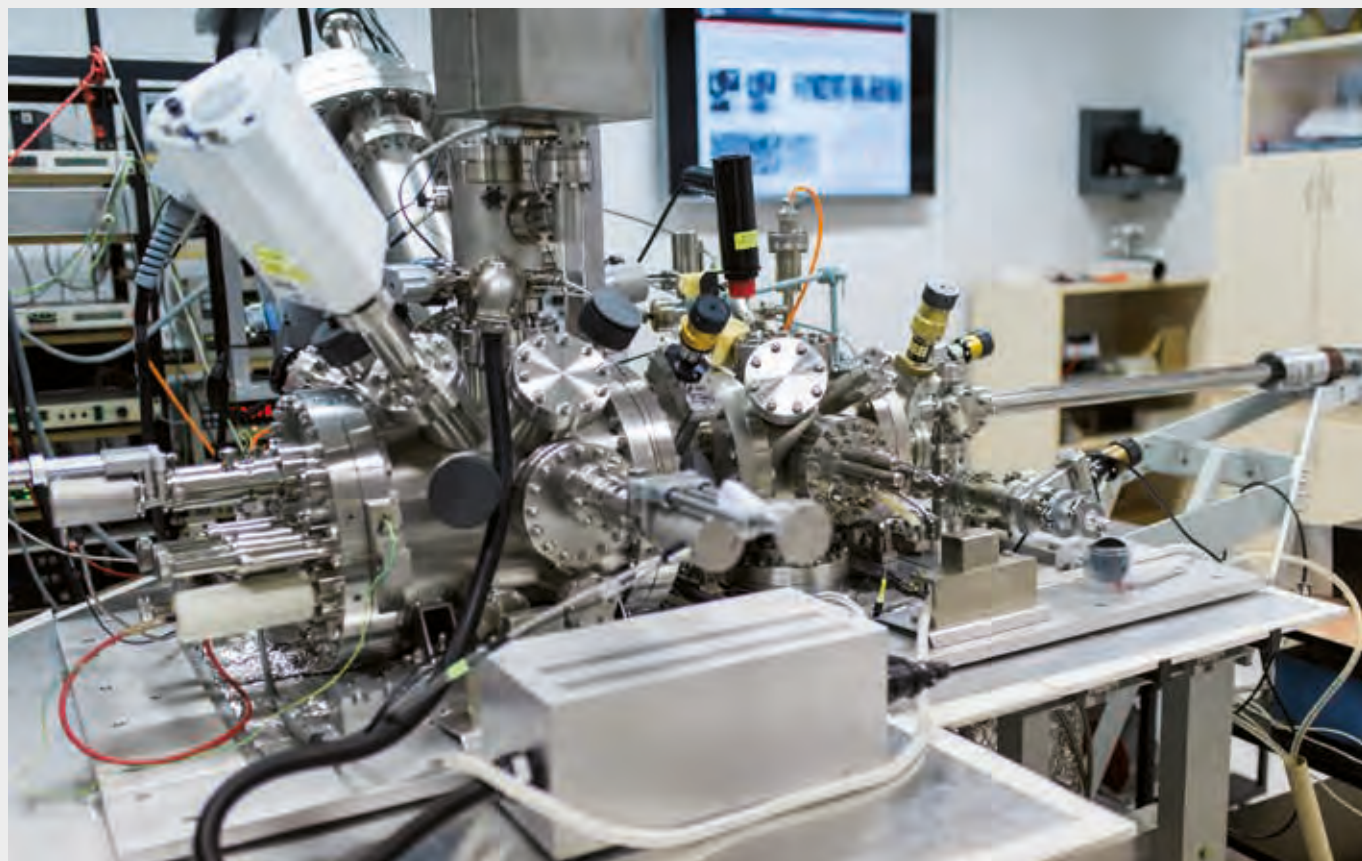
Chlubou Ústavu přístrojové techniky AV ČR je obří ultravysokovakuový rastrovací elektronový mikroskop, kterému se přezdívá „mamut“, a to nejen kvůli jeho velikosti, ale i proto, že dostal do výbavy speciální detektory a doplňky, čímž se stal unikátním na světě. Zařízení navrhli a z velké části sestavili právě zde.
