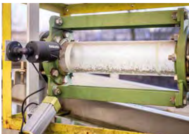
Část vnitřního experimentálního zařízení pro studium pohybu částic v proudící kapalině
